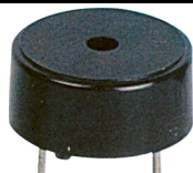
Piezo-Elm 22mm PC 4kHz 90dB 30V
