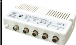
Антенско појачало 1 влез и 4 излези со напојување од 220 V и контрола на појачувањето Freq. range: 40 - 862 MHz Gain: 20 dB Gain control: 0 - 10 dB
